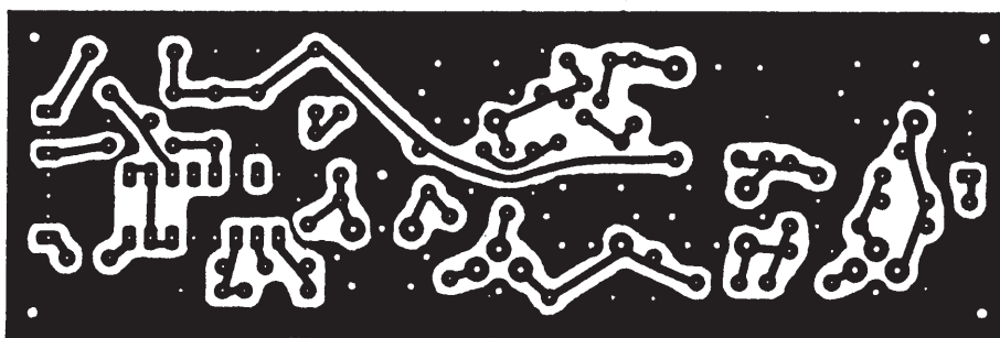
Slika 18 - Tiskanina medfrekvence sprejemnika (enostranski FR4, debeline 1.6 mm).
